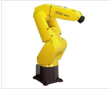
44. ábra: A tanszéken található Fanuc LR Mate 200iC típusú robot
