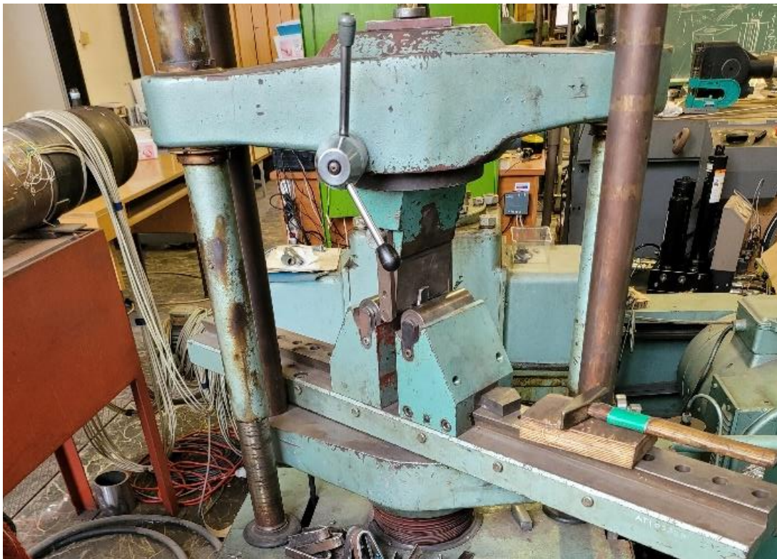
3. ábra: Mintadarab hajlítóvizsgálata.
