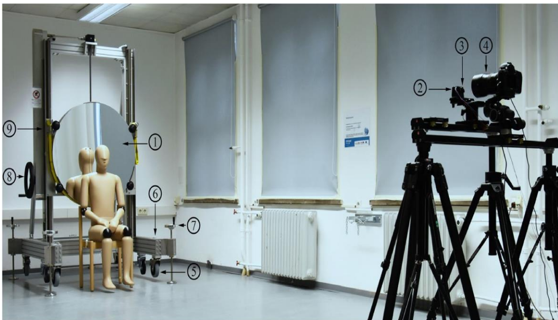
2. ábra: Schlieren képalkotási elrendezés [3].
