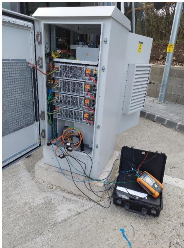
5. ábra: VOLÁN tulajdonú TITAN 120 kW típusú FCS EV gyorsító-állomás analízise.
