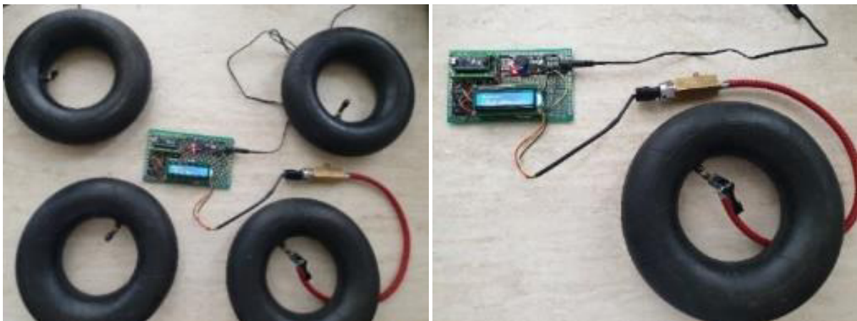
5. ábra: Gumipárnák nyomásának beállítása a rendszer földtől való mechanikai szigetelésére
