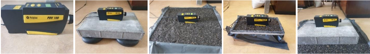
4. ábra: Padlóra, gumipárnákra- és betonlapra, 5 cm-vagy 16 cm napraforgómagra és betonlapra helyezett mérőeszköz
