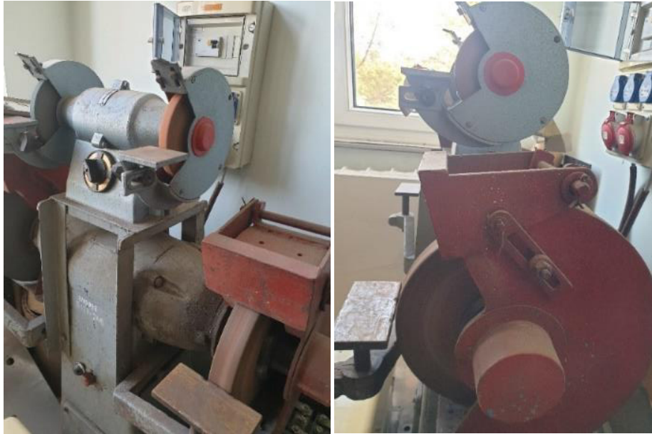
8. ábra: A Miskolci Egyetem Fizikai és Elektrotechnikai Intézetében található kis és nagy köszörű, mint mérhető rezgésforrás
